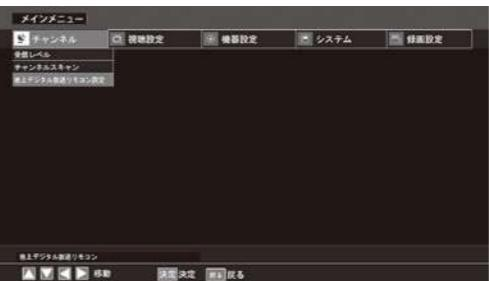
①現在登録されているチャンネルが一覧で表示されます。矢印ボタン(上下)で受信するかスキップするかを編集したいチャンネルにカーソルを合わせ、矢印ボタン(左右)で該当チャンネルの受信とスキップを切り換えることができます。スキップを設定すると、チャンネル+/-ボタンでチャンネルを切り換えるときに設定したチャンネルをスキップします。
